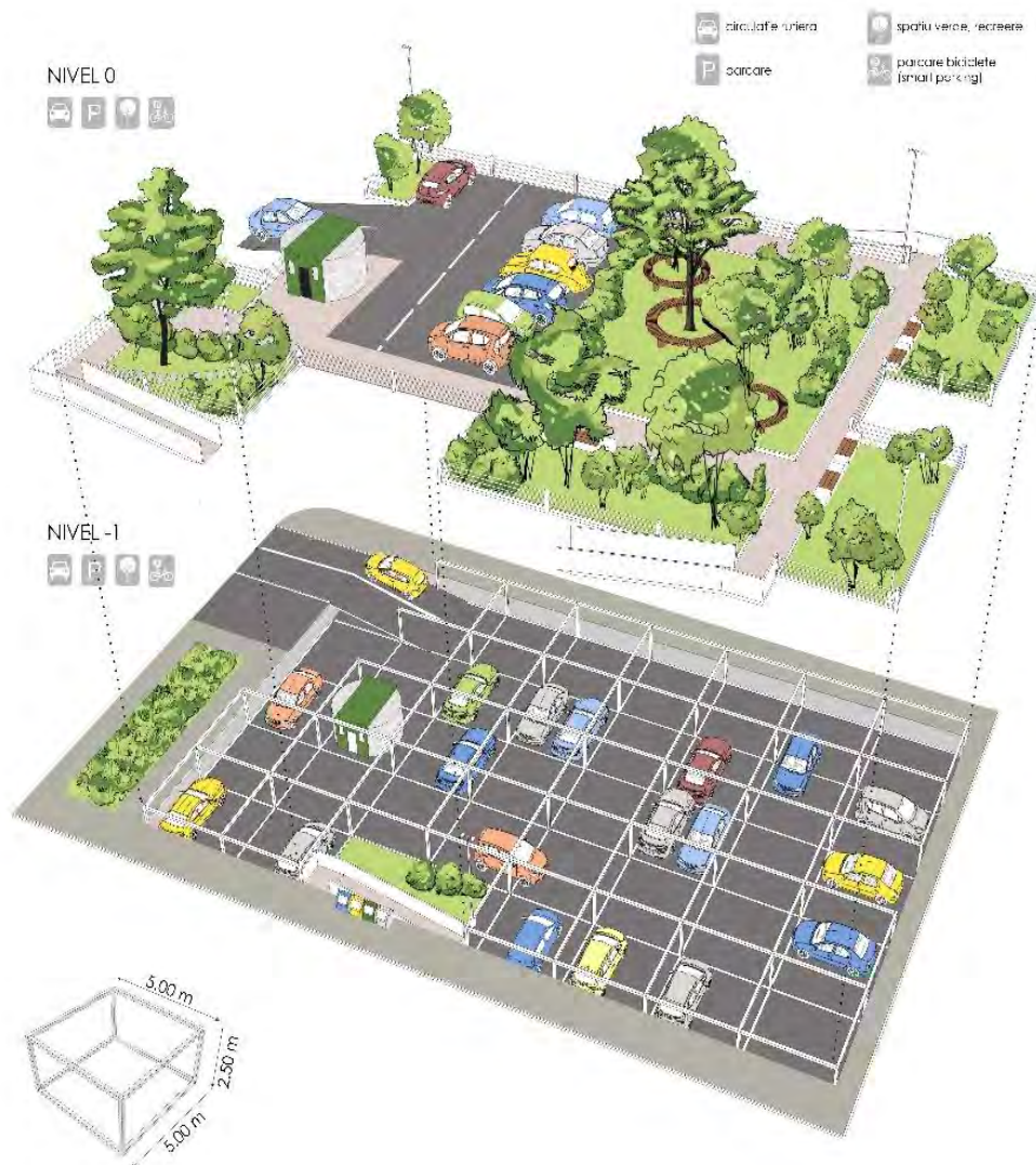
Figură 6-13 Axonometrie – varianta orientata catre amenajare spatiu verde si locuri de petrecere timp liber
